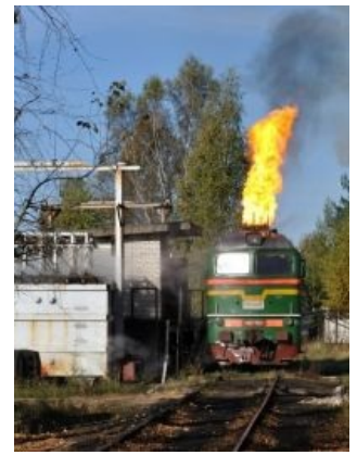
Тепловоз на реостатных испытаниях
