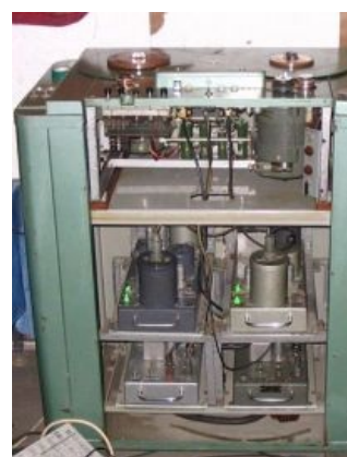
Трансляционный МЭЗ-28а весит 150 кг в сборе
