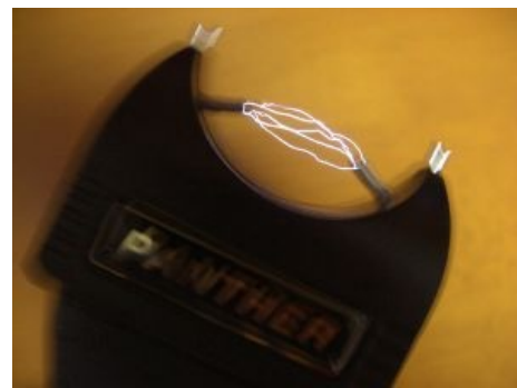
Электрошокер. Разряд между разрядными электродами
