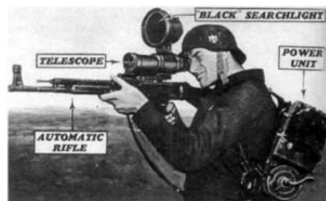
Шушпангеве́р для охоты на готов (с установленным инфракрасным прицелом Vampir)
