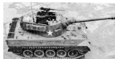
Американский убивец танков **M18 Hellcat** — брони нет, пушка не всегда пробивала в лоб **Тигры** даже подкалиберными снарядами, зато **80 км/ч**.
