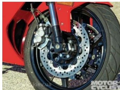
Корейский ABS — просто суппорт использует немного больше половины тормозного диска.
