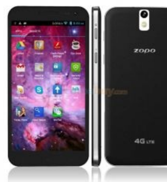
Типичный китайский флагман середины 2010-х. Процессор 8 ядер, камера 14 МПикс, 3 ГБ оперативки, дисплей 5.5" FullHD, поддержка сетей 4G LTE
